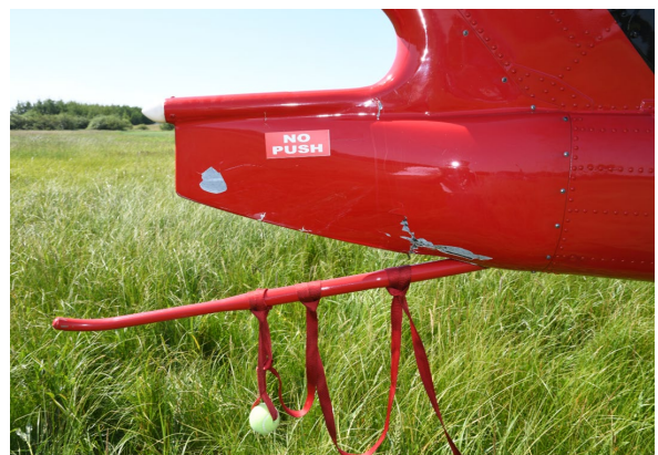
Figure 3. Dommages à la zone du sabot de queue du Bell 212 (Source : BST)
