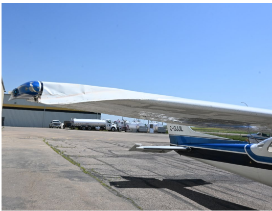
Figure 2. Dommages à l'extrémité de l'aile droite du Cessna 172 (Source : BST)
