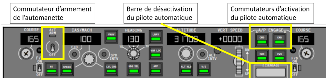
Figure 5. Le MCP, qui montre l'emplacement du commutateur d'armement (ARM) de l'automanette, la barre de désactivation (DISENGAGE) du pilote automatique et les commutateurs d'activation de commande (CMD) du pilote automatique (Source : The Boeing Company, avec annotations du BST)
