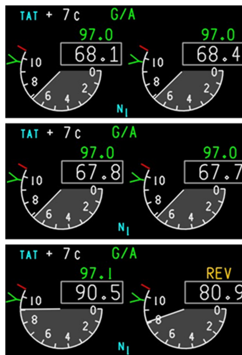
Figure 9. Indications du moteur N1 telles qu'elles seraient apparues pendant l'approche du vol à l'étude (en haut), après l'activation accidentelle du commutateur TO/GA (au milieu) et pendant la course à l'atterrissage, l'inverseur de poussée droit étant déployé et le moteur gauche s'efforçant d'effectuer une poussée presque complète (en bas) (Source : The Boeing Company)
