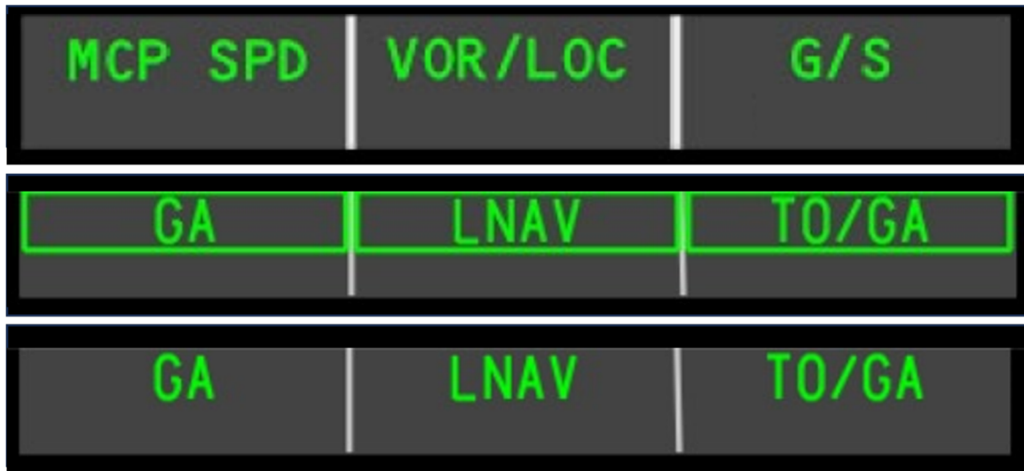
Figure 8. Indicateurs du tableau annonciateur de mode tels qu'ils auraient été affichés pendant l'approche (en haut), après l'activation accidentelle du commutateur TO/GA (au milieu) et après le toucher des roues (en bas) (Source : The Boeing Company)
