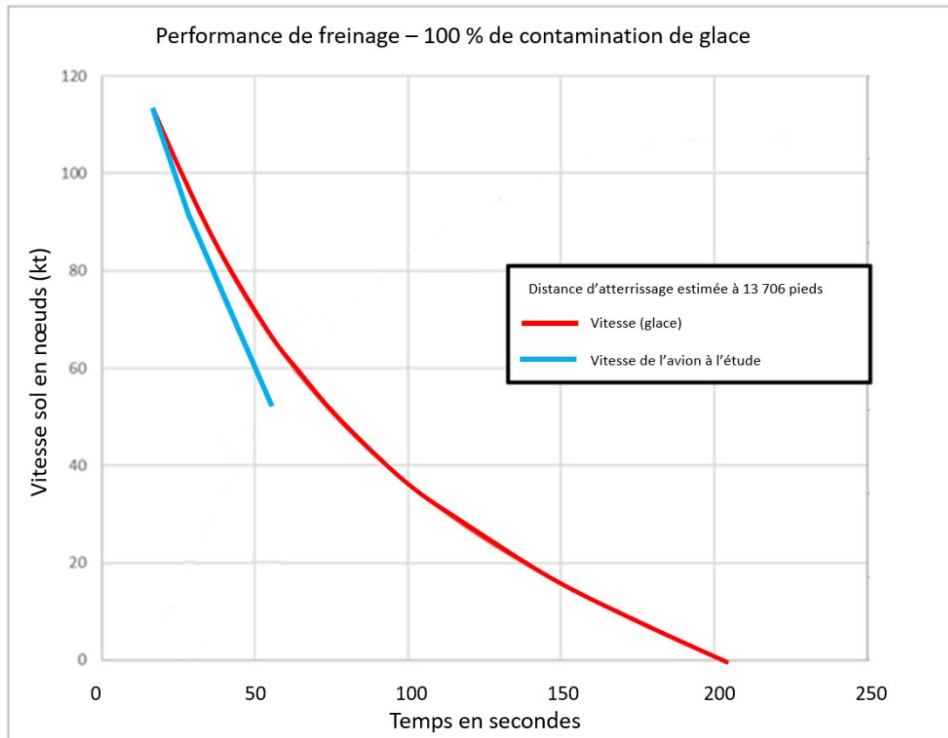
Figure 6. Graphique illustrant la performance de freinage prévue d'un HondaJet sur piste contaminée à 100 % avec de la glace et la performance de freinage de l'avion à l'étude – Scénario 5 (Source : BST)
