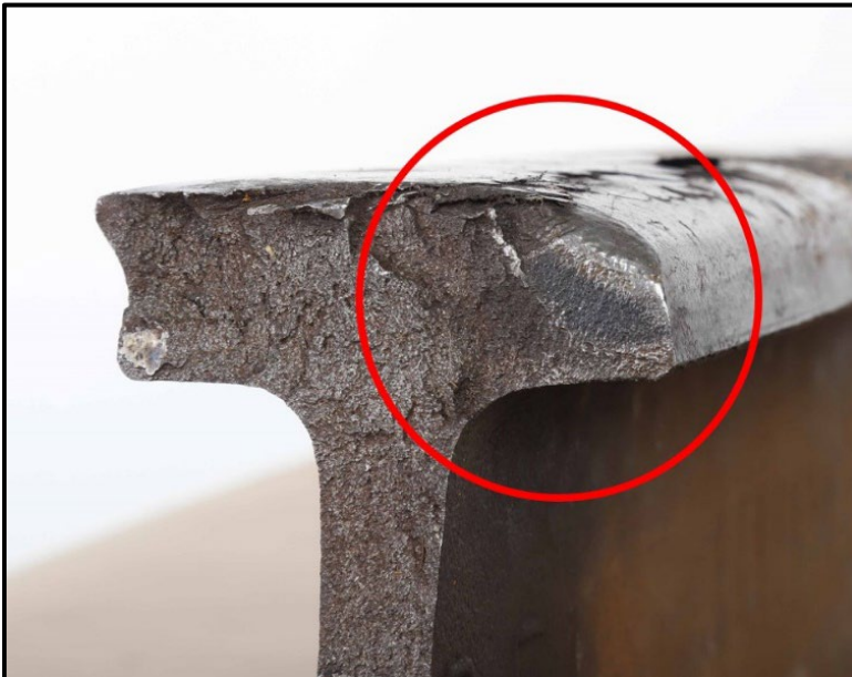
Figure 7. Fissure de fatigue sur le segment de rail n° 1 (Source : BST)
