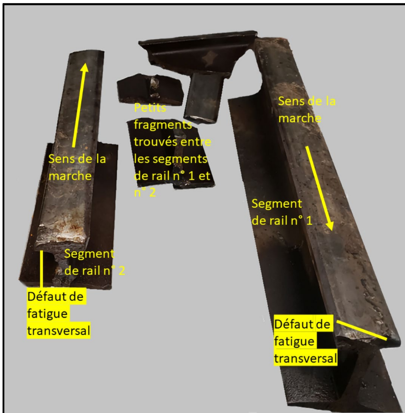
Figure 5. Segments de rail récupérés sur le lieu de l'événement (Source : BST)
