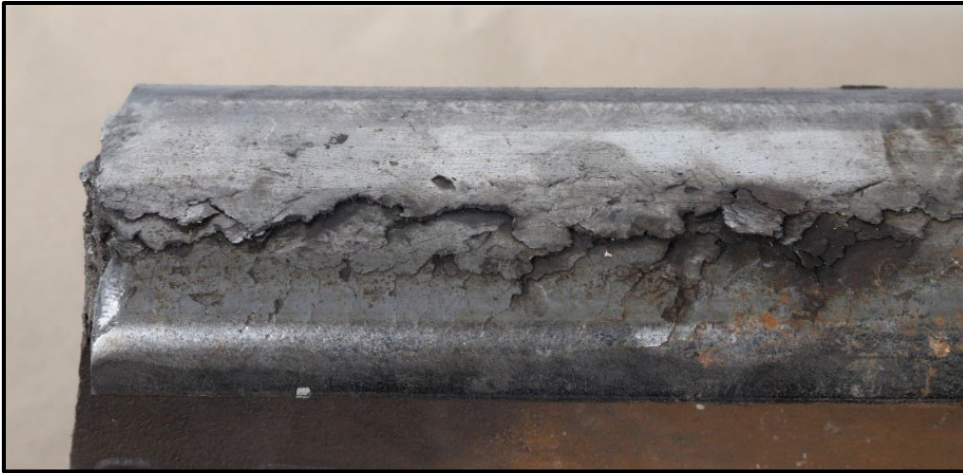
Figure 7. Fissure de fatigue sur le segment de rail n° 1 (Source : BST)
