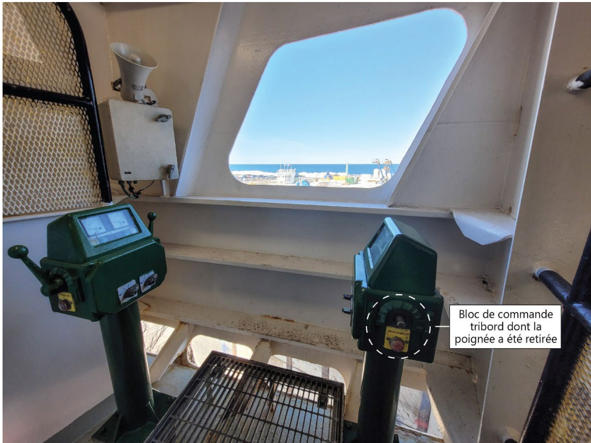
Figure 5. Vue du poste de commande tribord montrant les blocs de commande de l'équipement bâbord (à gauche) et de l'équipement tribord (à droite) (Source : BST)
