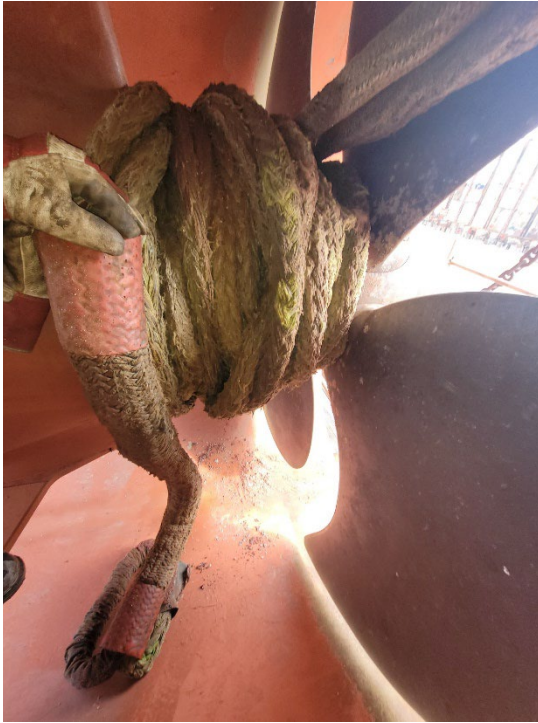
Figure 9. Gros plan de l'amarre enroulée sur le propulseur d'étrave (Source : Groupe Océan)
