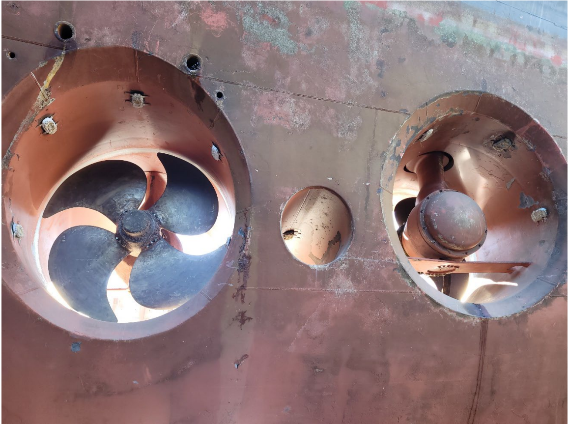
Figure 2. Vue de tribord des propulseurs d'étrave de l' Atlantic Vision (Source : BST)
