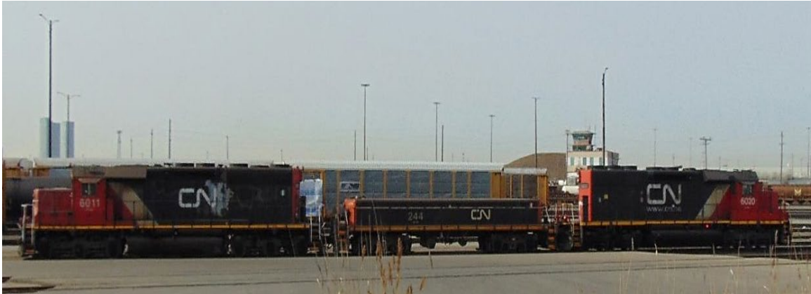
Figure 2. Groupe de traction de triage à butte de la Compagnie des chemins de fer nationaux du Canada à la gare de triage MacMillan (Source : BST)
