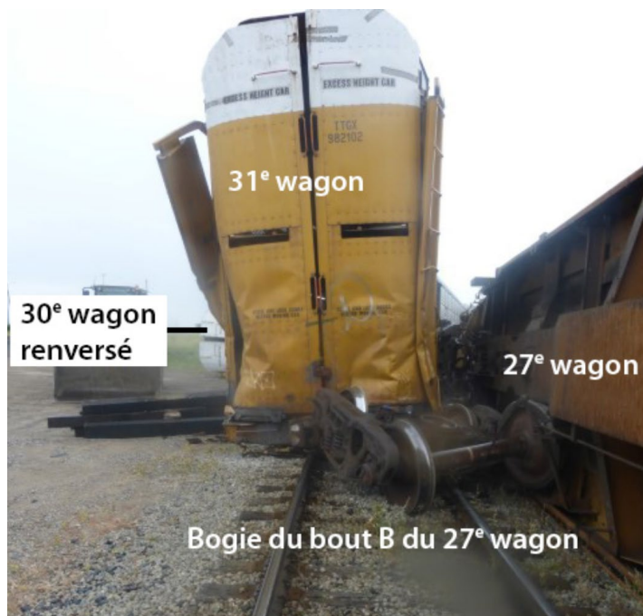
Figure 9. Extrémité avant du 31 e wagon (TTGX 982102) et bogie arrière du 27 e wagon (Source : BST)
