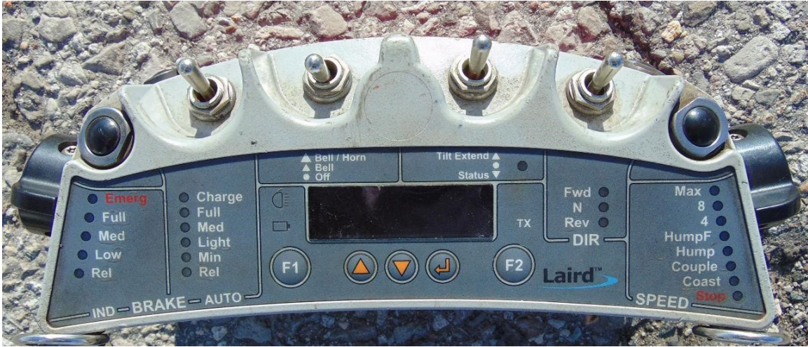
Figure 13. Télécommande de locomotive, aussi appelée « Beltpack » (Source : BST)
