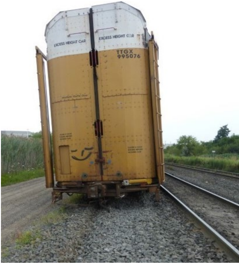
Figure 5. Bogie du bout B (arrière) du 26 e wagon (TTGX 995076) ayant déraillé; le bogie du bout A est demeuré sur les rails (Source : BST)
