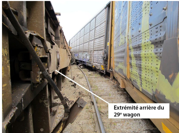
Figure 8. Vue de l'arrière du 29 e wagon, immobilisé à environ 2 pieds du rail intérieur de la courbe. À noter qu'il y a des bogies manquants (Source : Compagnie des chemins de fer nationaux du Canada)
