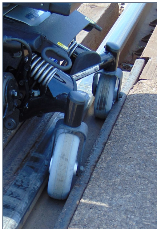
Figure 6. Roulettes arrière d'un exemplaire de référence du fauteuil roulant, coincées dans l'ornière du passage à niveau à l'étude (Source : Gendarmerie royale du Canada)
