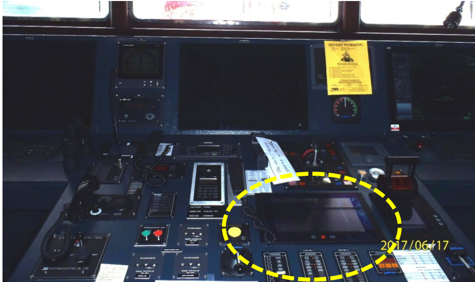
Figure 2. La console centrale de la passerelle du Damia Desgagnés, où est installé sur un plan horizontal l'écran tactile du système de navigation intégré qui a été activé et a causé l'arrêt accidentel de la machine principale
