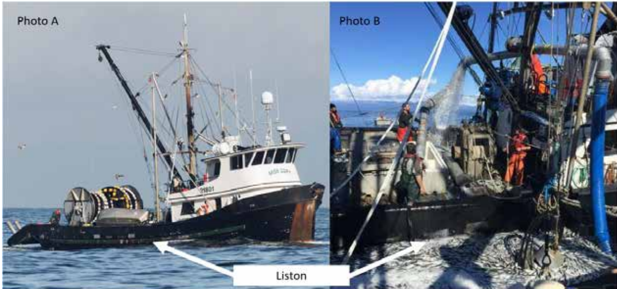
Figure 3. Le liston du Miss Cory apparaît au-dessus de la surface de l'eau pendant la navigation (photo A) et disparaît sous l'eau lorsque le bateau gîte durant les opérations (photo B).
