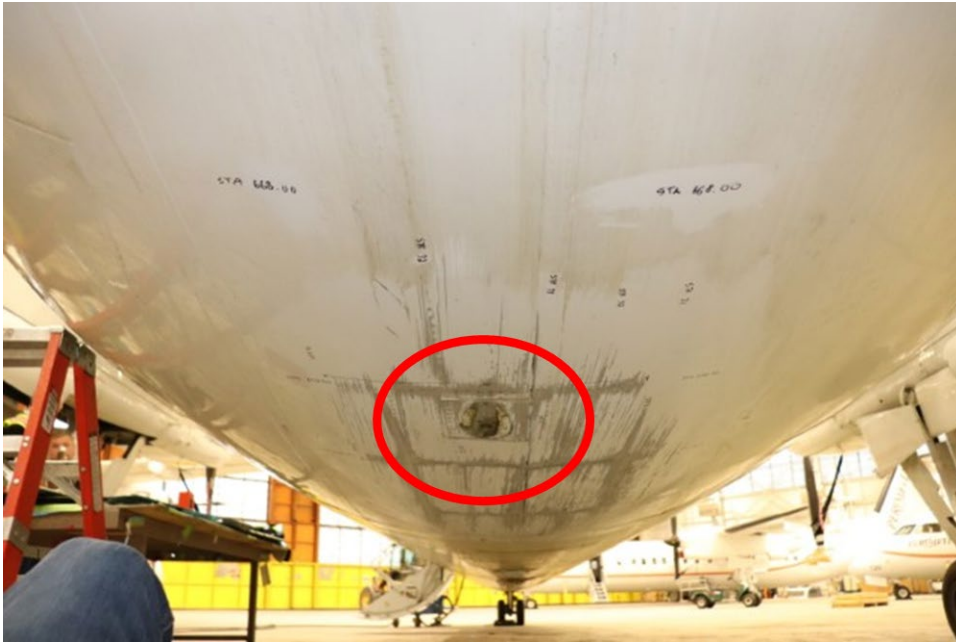
Figure 3. Vue extérieure de la partie arrière du fuselage de l'aéronef à l'étude, montrant le coupe-circuit en cas de contact queue-sol manquant (Source : BST)
