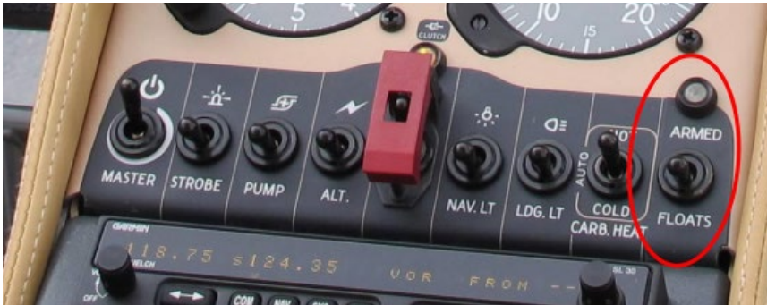
Figure 4. Tableau de bord inférieur montrant l'interrupteur d'armement et le voyant des flotteurs (Source : Guimbal, Bulletin de service SB 15-004 D : Pop-out Floats Capability 2 Installation [7 février 2016], p. 4/16, avec annotations du BST)
