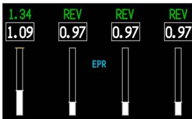
Figure 4. Indication d'inversion de poussée dans le système d'affichage des paramètres réacteurs, de mise en garde et d'alarme du Boeing 747 (Source : Renseignements exclusifs de Boeing. © Boeing. Repris avec l'autorisation de la compagnie Boeing)
