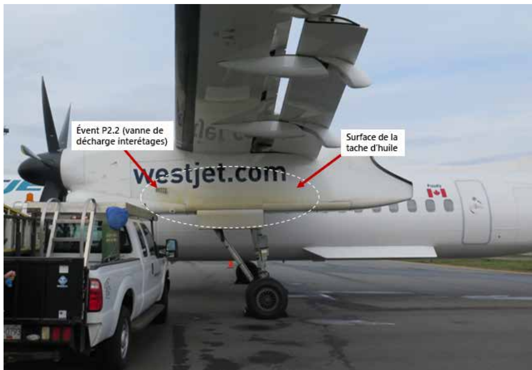
Figure 1. Huile sur la nacelle moteur gauche
