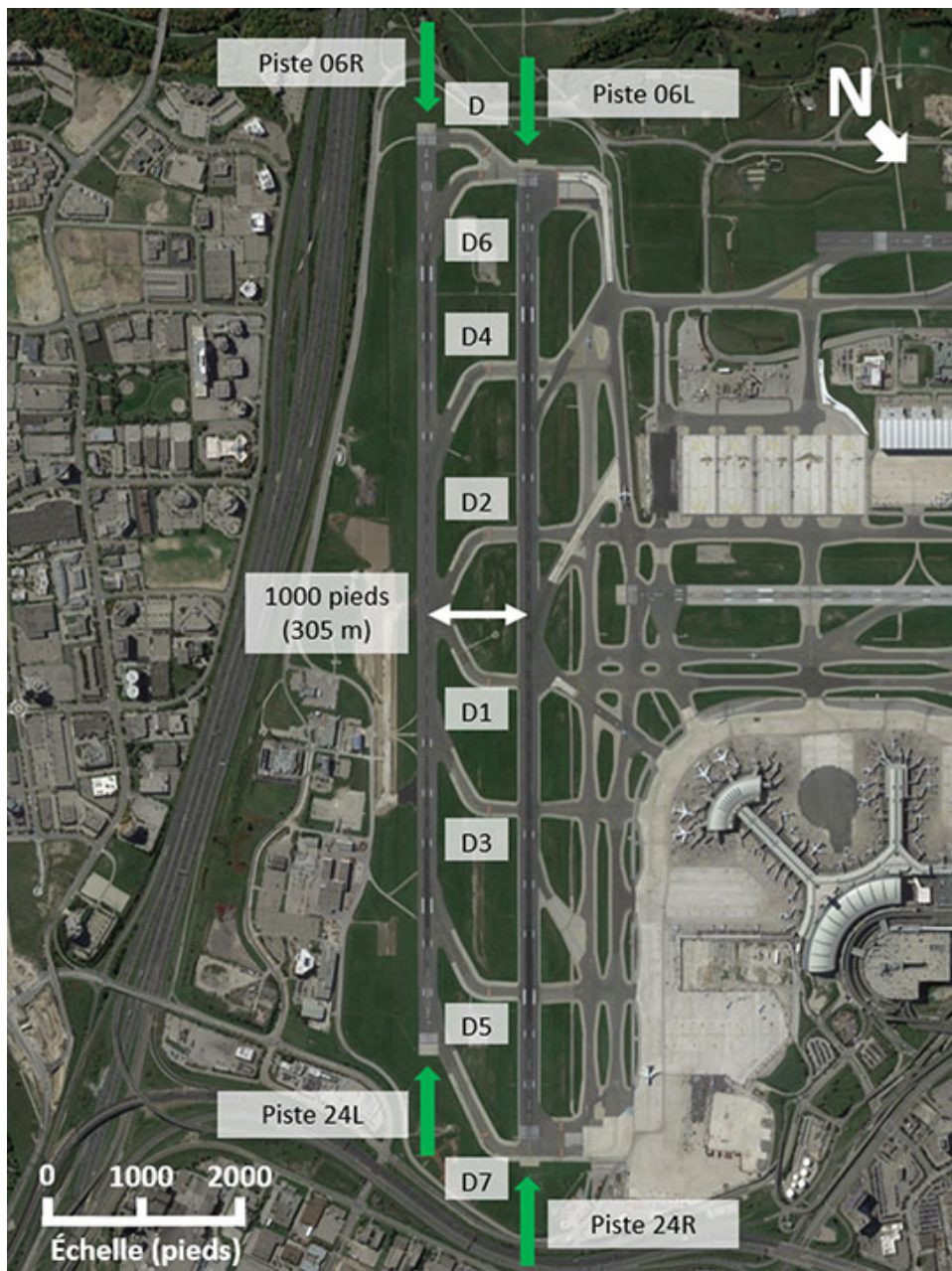
Figure 4. Représentation des pistes et des voies de sortie rapide du complexe sud à CYYZ (Source : Google Earth, avec annotations du BST)
