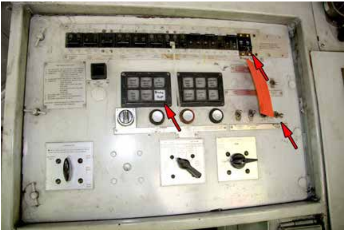
Figure 2: Composants de l'essai de frein dans la cabine de la locomotive
