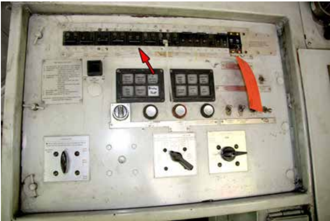
Figure 4: Disjoncteur de commande dans la cabine de la locomotive
