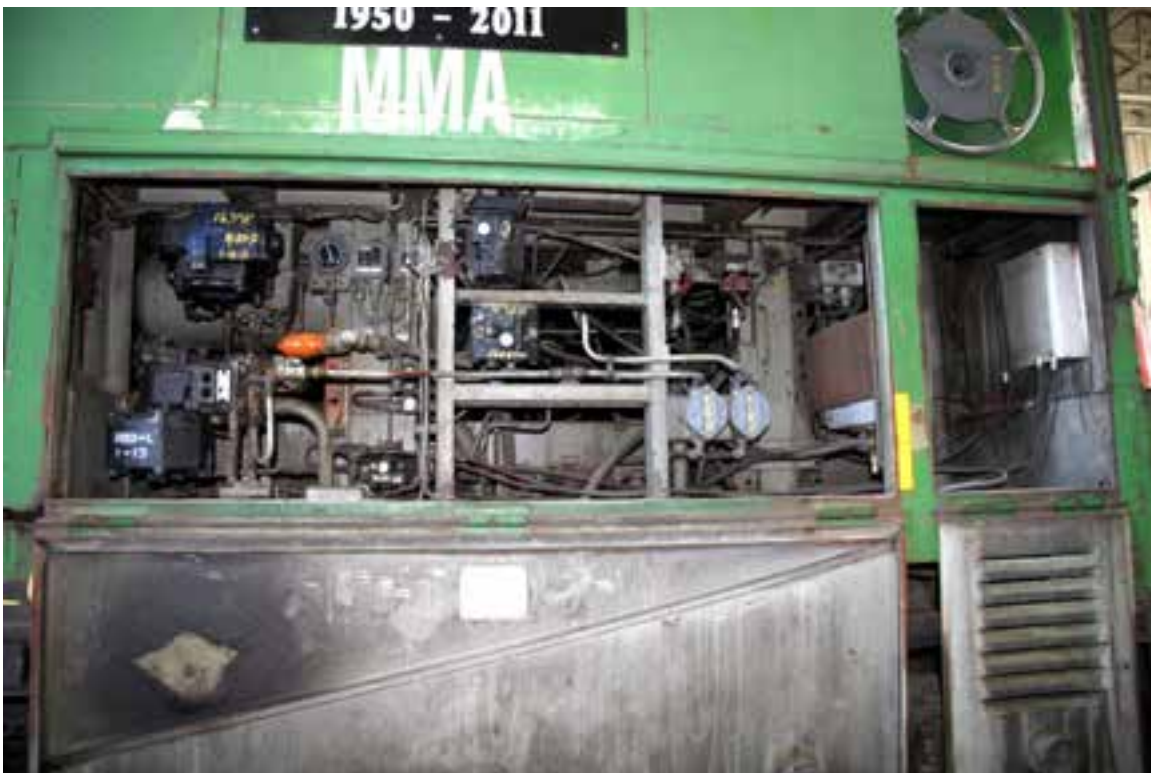
Figure 8: Compartiment du frein à air de la locomotive 5026
